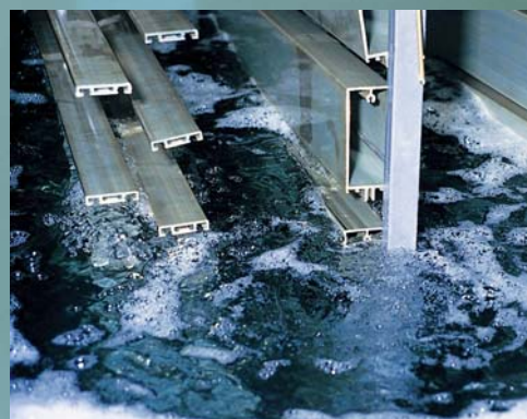
Eine perfekte Vorbehandlung ist Voraussetzung für die optimale Beschichtung.
